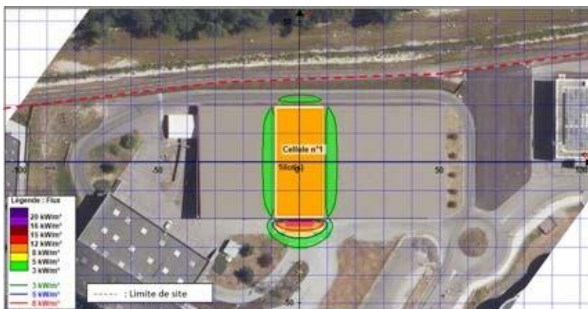
Figure 13. Effets thermiques associés à un incendie du stockage de CS dans l'alvéole 3
